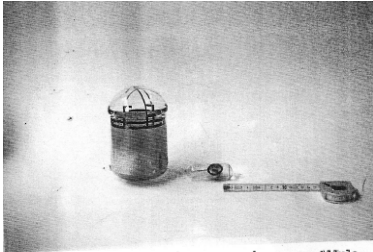
Photo-cathode de 84 mm. de \varnothing dans sa cellule pour la caméra Grand Champ.
